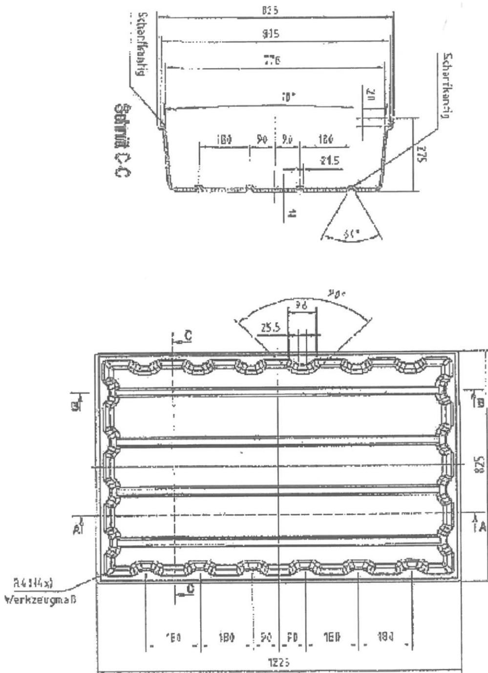
Auffangvorrichtungen aus Polyethylen (PE)
